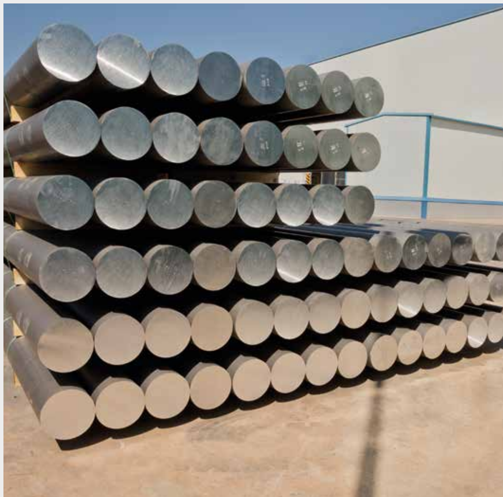
Lingotti cilindrici detti anche "billettes", per ottenere profili in alluminio dritti ed eliminare ogni tensione nel materiale, vengono stirati. Vengono quindi tagliati in lunghezze adeguate e invecchiati artificialmente per ottenere la resistenza appropriata.
