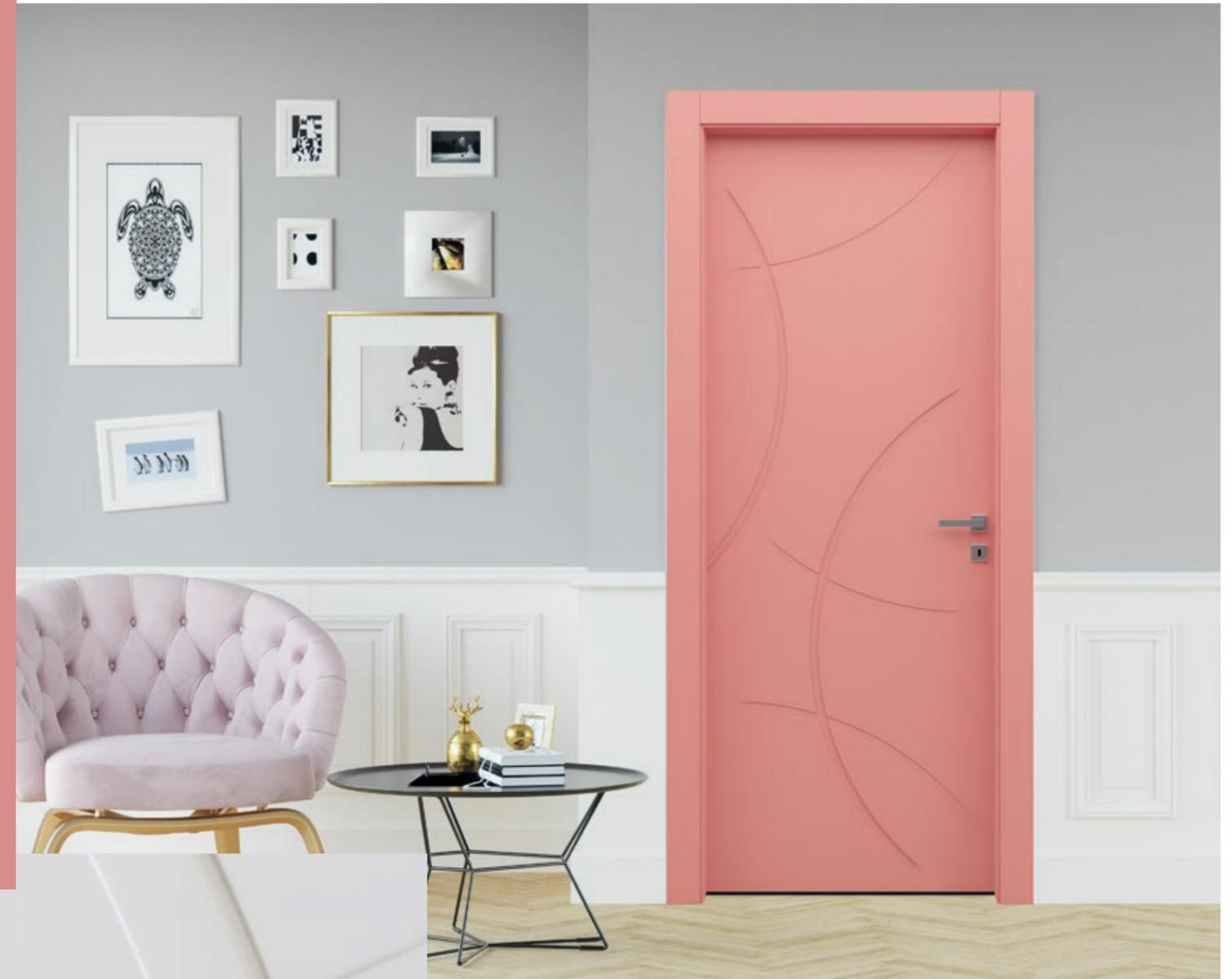
→ **P**orta interna tamburata, incisa laccata su base HDF da 8mm con telaio in legno massello stonato R50 o piatto R3 da cm 11 di spessore guarnizione in battuta e coprifili telescopici stonati o piatti ad incastro.
